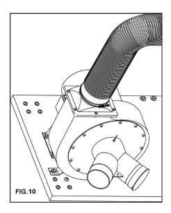
10. THE DUST COLLECTOR IS NOW READY TO BE PLACED INTO SERVICE. BEFORE CONNECTING TO A POWER SOURCE, BE SURE THE POWER SOURCE IS PROPERLY GROUNDED AND IS OF PROPER VOLTAGE AND AMPERAGE.
